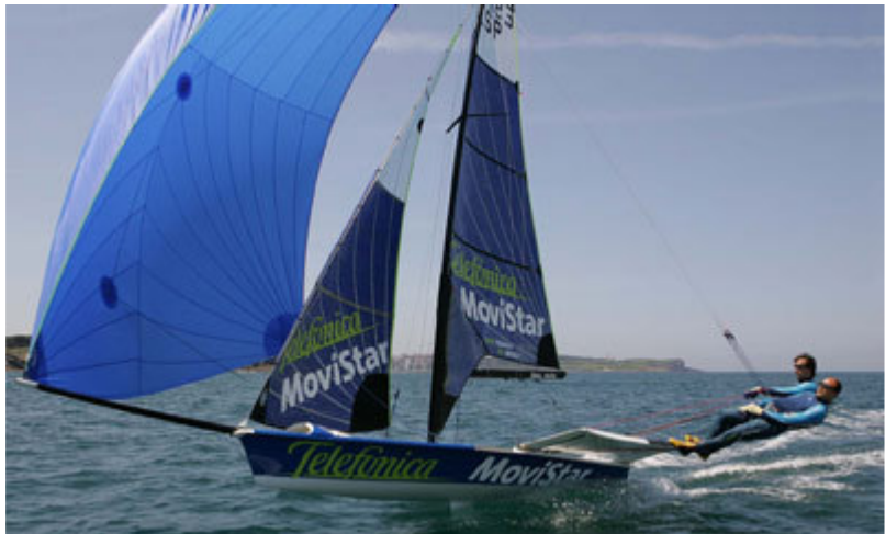
El spinnaker asimétrico va amurado a un botalón (49er)
