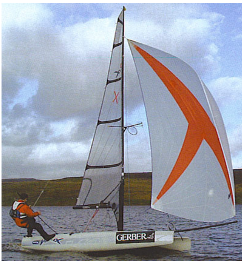
En esta imagen se aprecia la solapa que presenta el grátil del spi (Laser Vortex)
