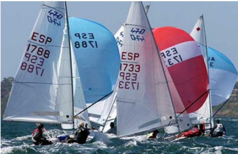
El spinnaker simétrico va amurado a un tangón (470)
