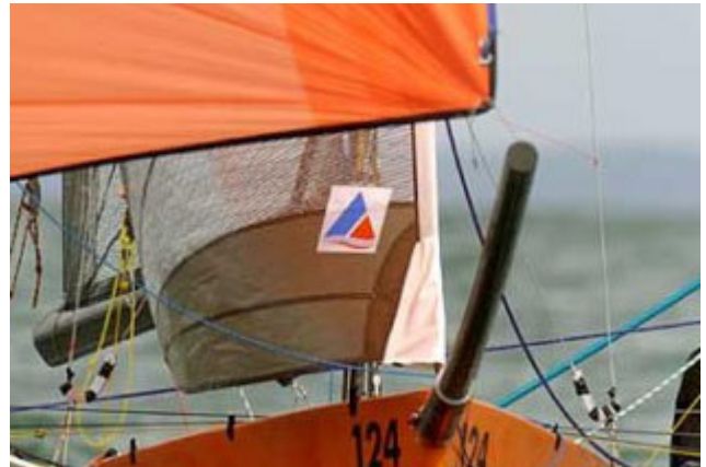
El puño de amura del asimétrico debe ir ligeramente separado del tangón (Internacional 14)
